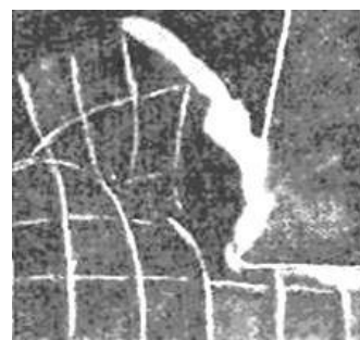
Рисунок 3.4 – Искажение координатной сетки в результате деформации
