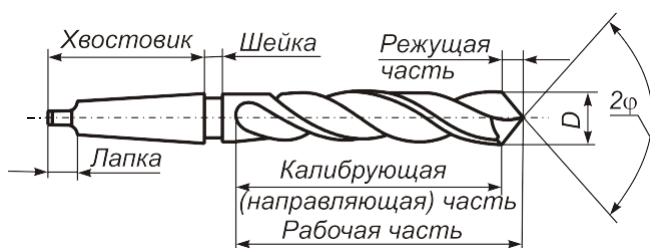
Рисунок 1.26 – Общий вид и основные элементы конструкции винтового сверла
